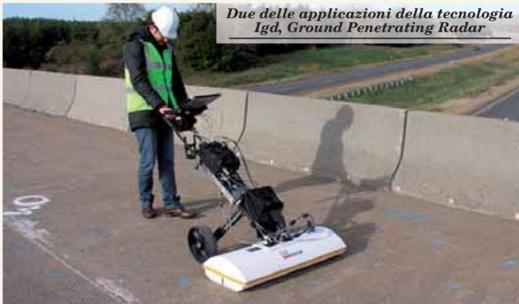
*Due delle applicazioni della tecnologia Igd, Ground Penetrating Radar*
